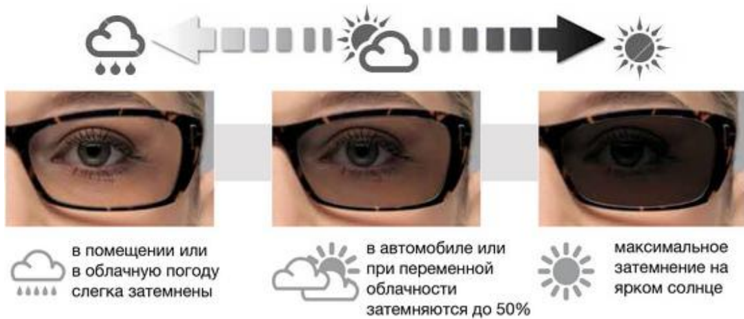
Рисунок 33 – Степень затемнения фотохромных линз в зависимости от освещения
