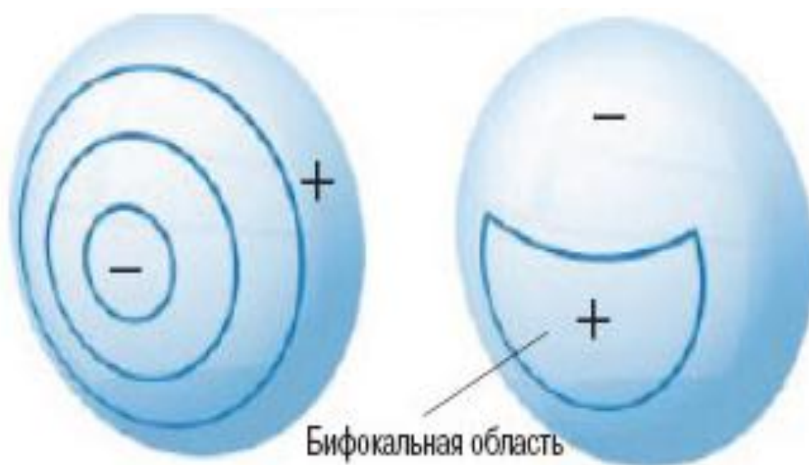
Рисунок 69 – Расположение различных кольцевых оптических зон в мультифокальных контактных линзах
