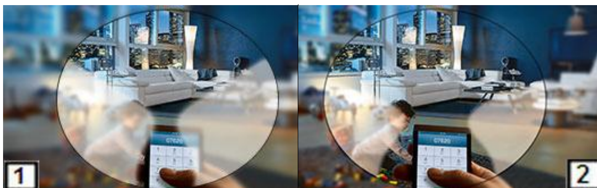
Рисунок 39 – Периферические искажения в линзах: со стандартным коридором прогрессии (1), с расширенным коридором прогрессии (2)
